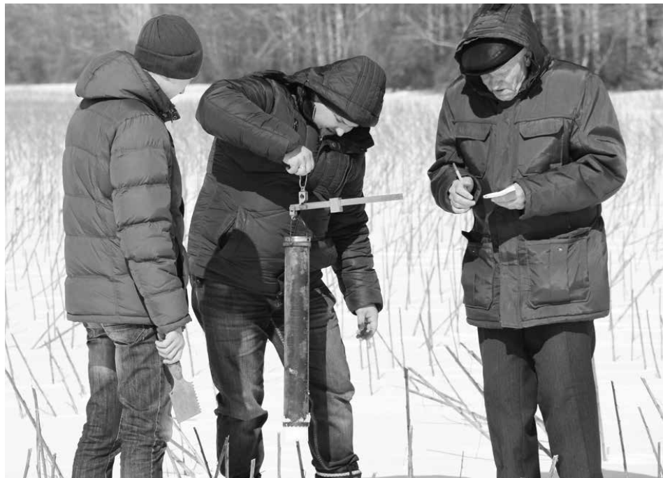
Микола Опара (праворуч), Сергій Козін та Родіон Морозов проводять заміри товщини снігового покриву
